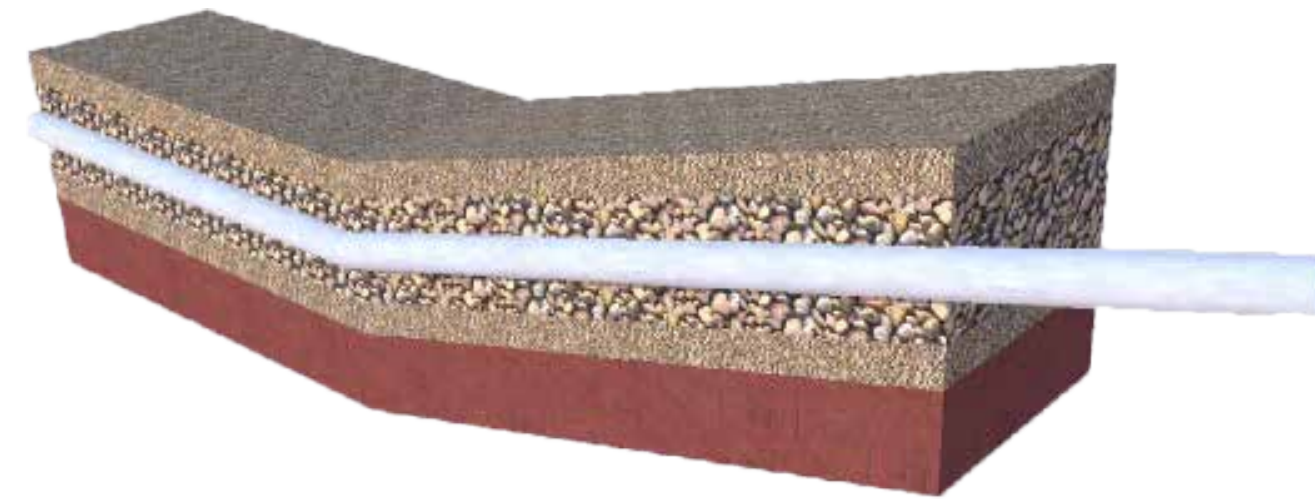
Lixiviat pompé dans le monticule en surface
