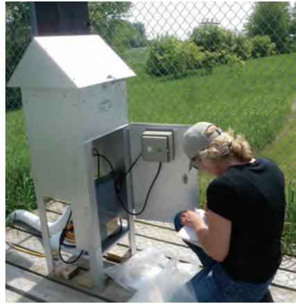
Un technicien remplace le filtre dans un échantillonneur d'air à grand volume
