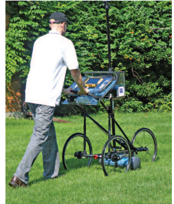
Des outils fondés sur le GPS serviront à balayer la surface d'une propriété afin d'en recueillir des relevés de rayonnement gamma.
