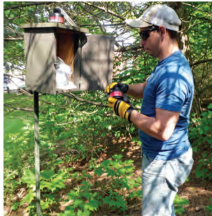
Contrôle de la qualité de l'air avec un échantillonneur d'air à grand volume et un moniteur de radon
