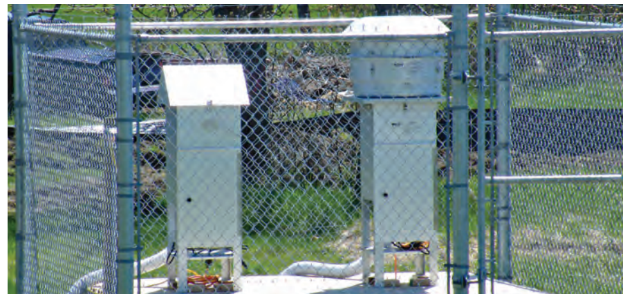
Des échantillonneurs à grand volume fixes contrôlent continuellement la qualité de l'air
